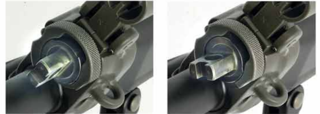
Stellungsspiel: Links die Gasdüse in der Normalstellung, rechts bei starker Verschmutzung oder für sehr tiefe Temperaturen.
